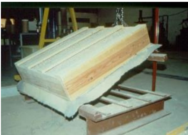
Figure 79. Plan incliné de l'IRSTEA simulant le multi-couche du parement amont du barrage de l'Aubrac.
