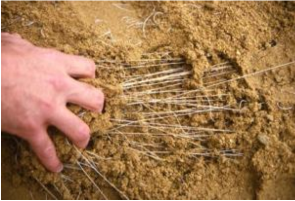
Figure 36. Vue du sable micro-renforcé ; le renforcement est tridimensionnel.
