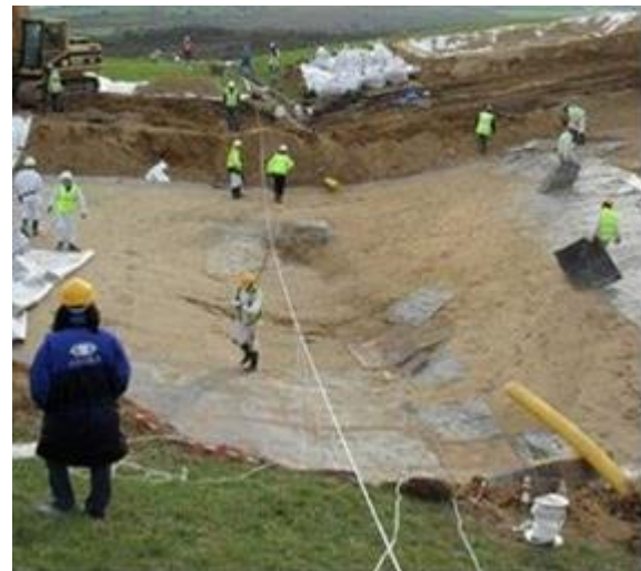
Figure 92. CSM de La Hague : prélèvement d'échantillons dans la zone de tassement différentiel (2011).
