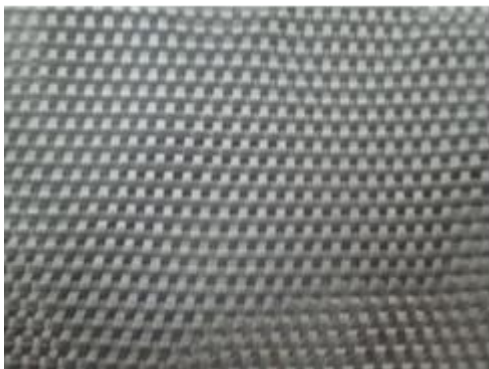
Figure 13. Vue rapprochée du géotextile tissé utilisé pour le massif renforcé de Prapoutel (1982).
