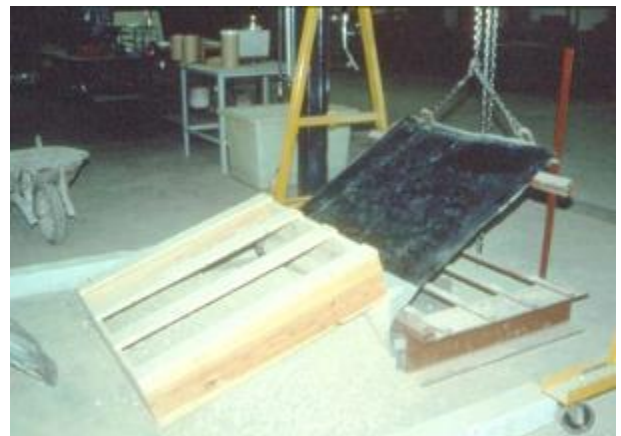
Figure 80. Plan incliné de l'IRSTEA : Glissement obtenu par augmentation de l'inclinaison.
